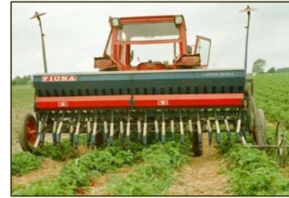
Udlægning af rovmider vha. ombygget Fiona såmaskine (ca. 2 timer/ha.)
